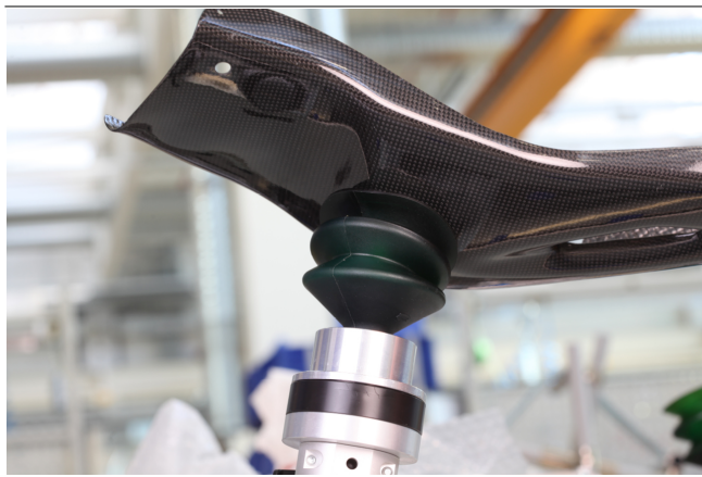
Uni-Base UB e riferimento di ventosa RSC per il bloccaggio di un pezzo CFK
